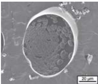
REM-Aufnahmen zeigen die Bakterienverteilung von Pseudomonas-aeruginosa-Kolonien auf dem PU-Schaum (links, Mitte) und auf den Superabsorberpartikeln im Silikonvlies des PU-Schaum-Komposits 2 .
